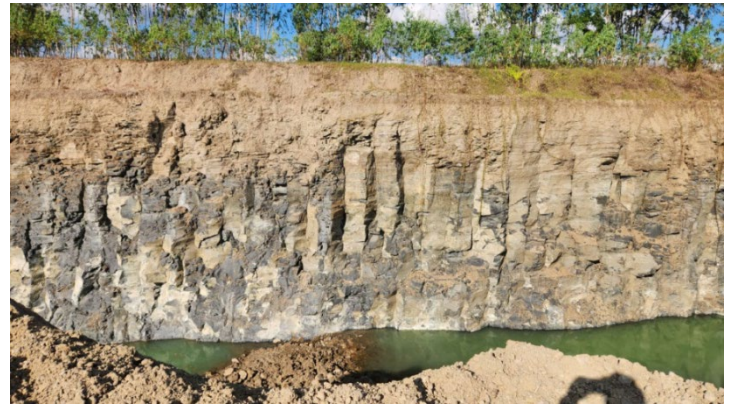
ลักษณะสภาพผนังหน้าเหมือง แสดงส่วนของหน้าดินและหน้าหินในพื้นที่ทำเหมือง
